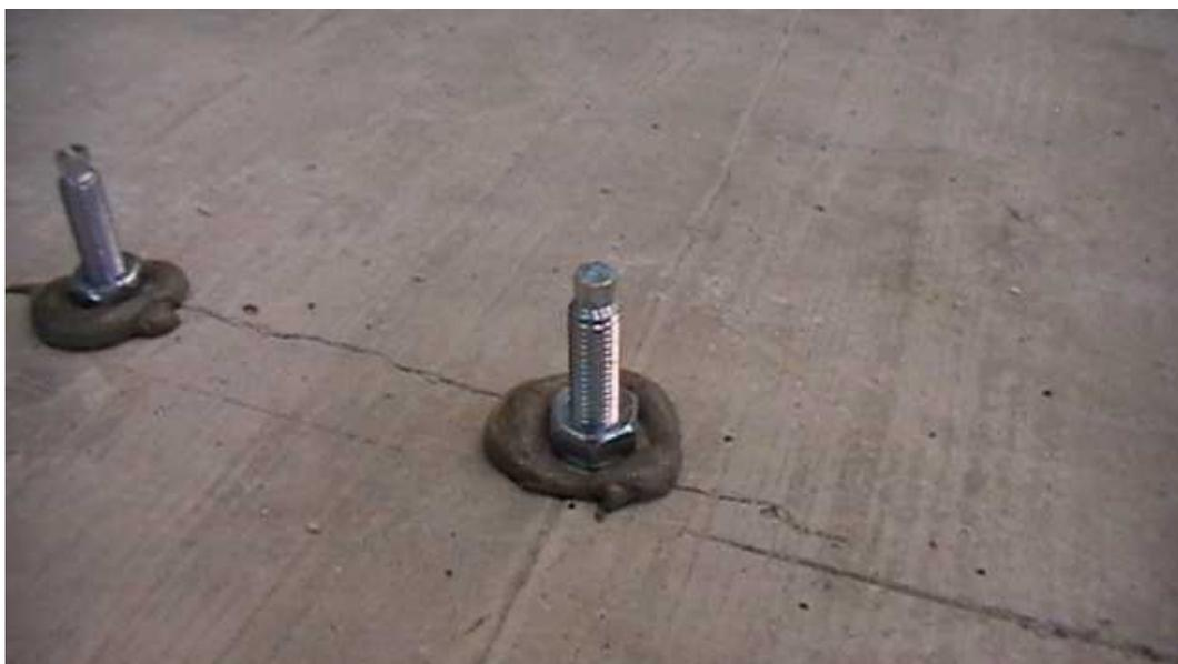
**Рис.4.2.** а) Анкер марки S-UF 10×100 (SORMAT) после установки в железобетонную плиту с трещиной; б) химический анкер марки ITH 380 Ø 10 мм с  $L_{\text{анк}} = 90$  мм (SORMAT) после установки в железобетонную плиту с трещиной.
