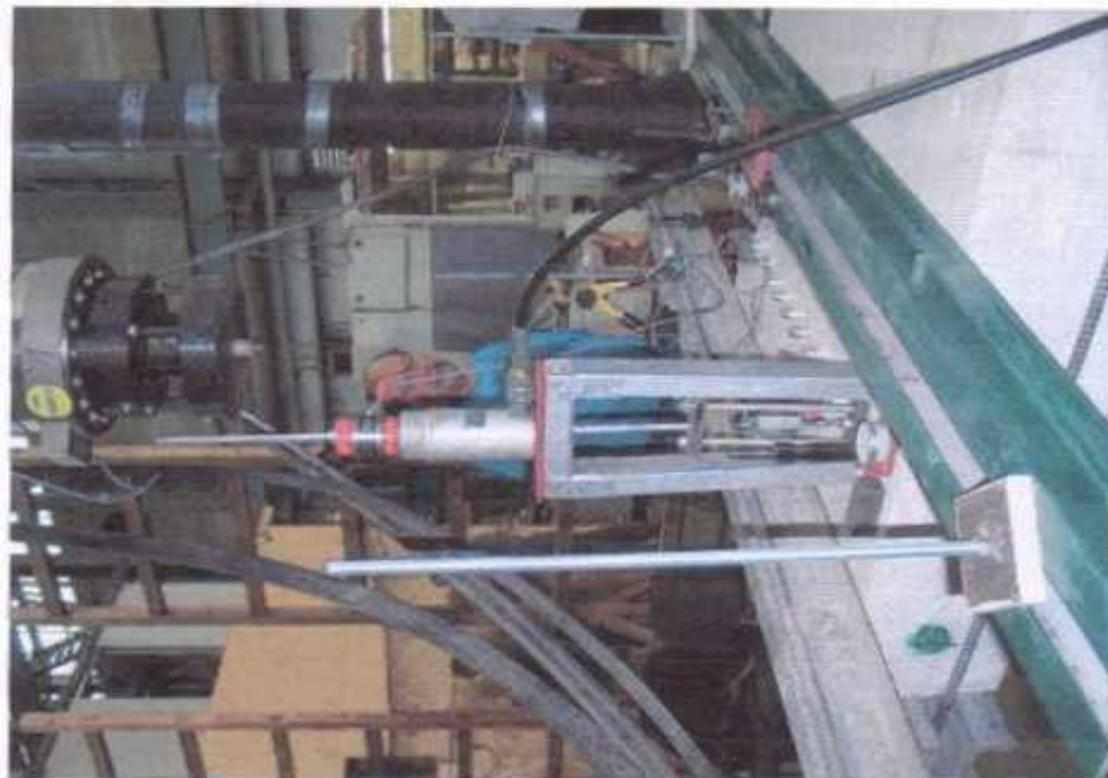
**Рис.4.1.** Общий вид установки для динамических испытаний анкеров на вырыв из железобетонной плиты (а) и рабочего органа установки с прибором для измерения ширины раскрытия трещины.
