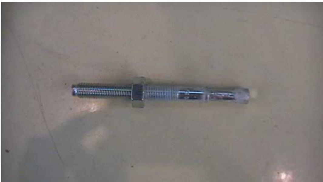
**Рис.4.11.** Разрушение анкерного узла при вырыве из бетонной плиты с трещиной при использовании анкера марки S-KA 10/30 (SORMAT).
