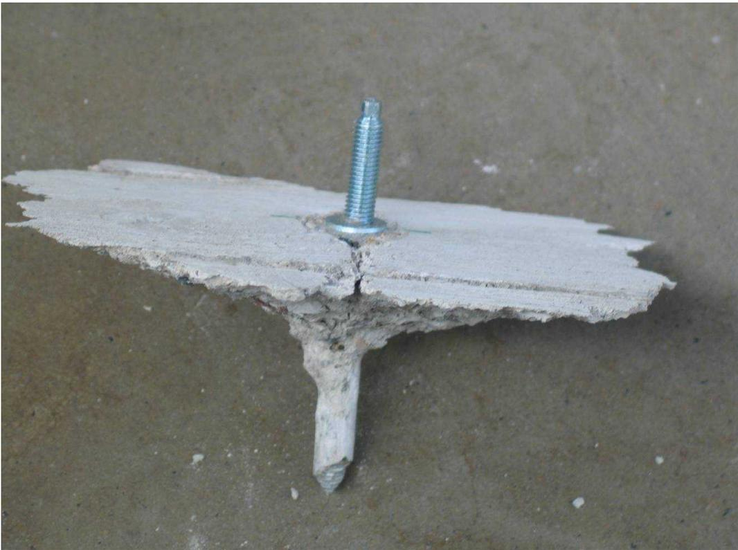
**Рис.4.10.** Разрушение анкерного узла при вырыве из бетонной плиты с трещиной при использовании анкера марки: а) S-UF 10×100 (SORMAT); б) ITH 380 Ø 10 мм с  $L_{\text{анк}} = 90$  мм (SORMAT).
